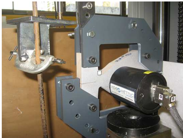
Dispositif expérimental en mode I ( \beta=0^\circ , hêtre)
