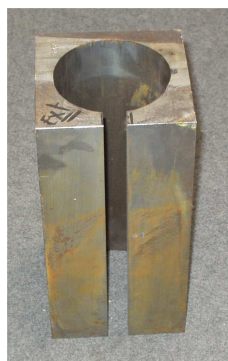
Figure 2.1 – Echantillon de 16MND5 ayant servi aux prélèvements des éprouvettes de nuance A.
