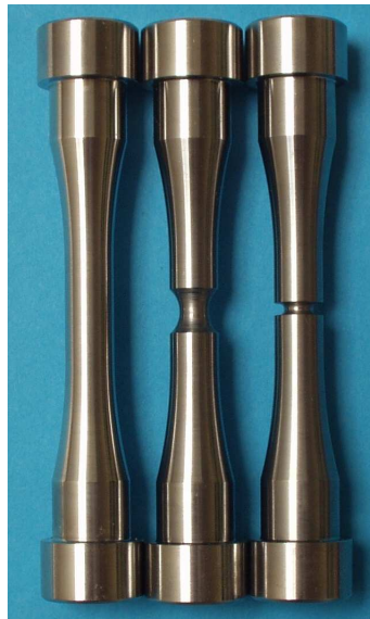
Figure 4.13 – Photos des différentes géométries des éprouvettes usinées.
