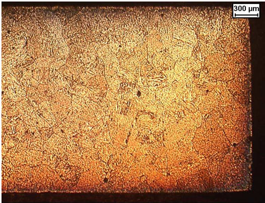
Figure 2.20 – Anciens grains austénitiques de la nuance B après maintien de 5h à 1100°C.
