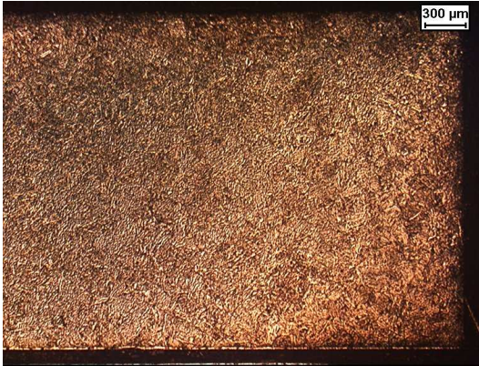
Figure 2.18 – Anciens grains austénitiques de la nuance B après maintien de 30mn à 1100°C.
