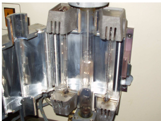
Figure B.7 – Four du dilatomètre de trempe
