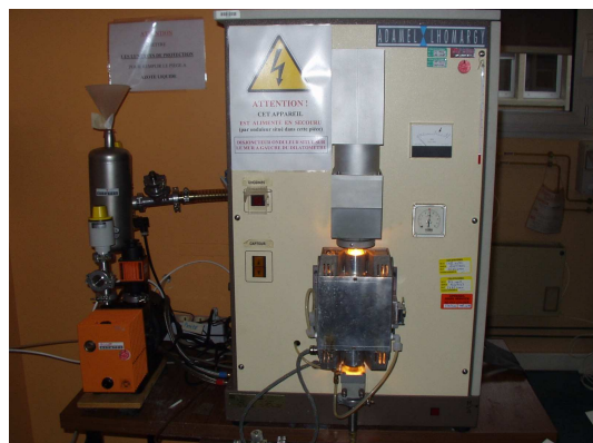
Figure B.6 – Dilatomètre de trempe DT1000 en fonctionnement
