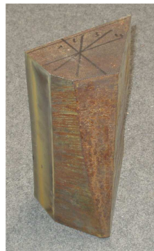
Figure 2.2 – Echantillon de 16MND5 ayant servi aux prélèvements des éprouvettes de nuance B.
