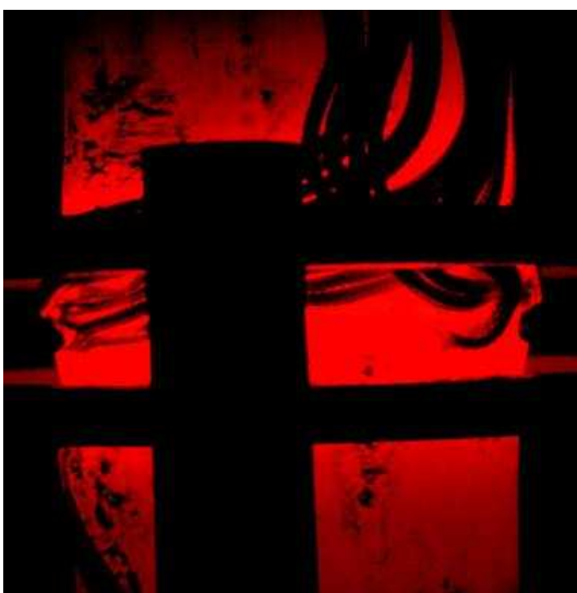
Figure 1.10 – Essai RUP THER sur un tube chauffé et sous pression interne.
