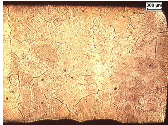
Figure 2.21 – Anciens grains austénitiques de la nuance A après maintien de 5h à 1100°C.
