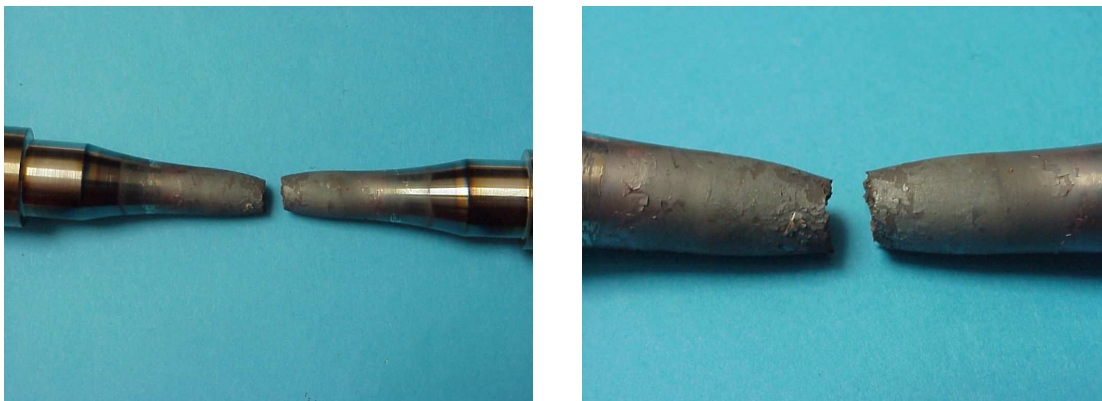
Figure 4.19 – Photos de l'éprouvette après rupture.
