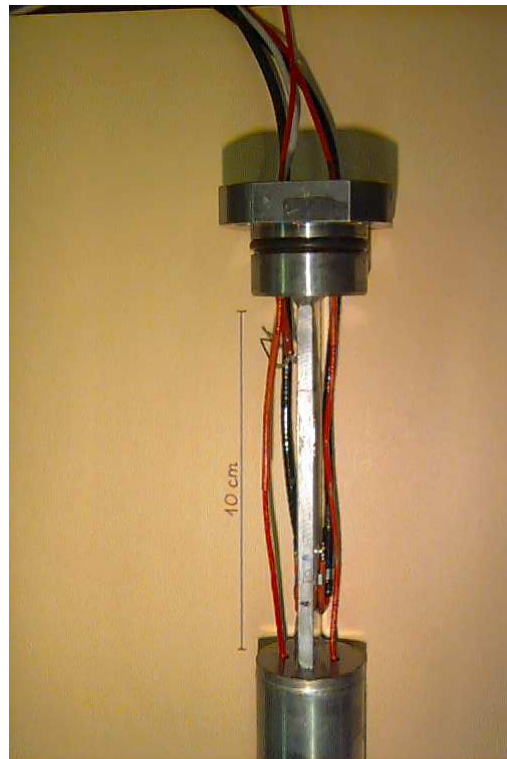
FIG. B.10 – Plaques piézo-électriques avant la pose de la couche d'étanchéité.
