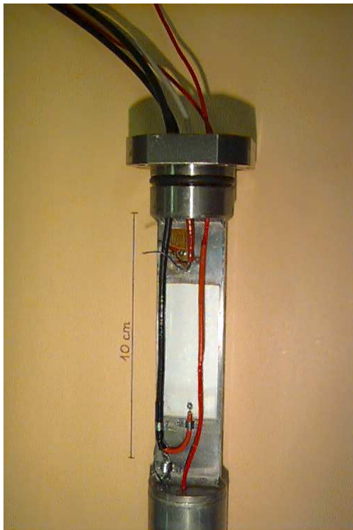
FIG. B.10 – Plaques piézo-électriques avant la pose de la couche d'étanchéité.
