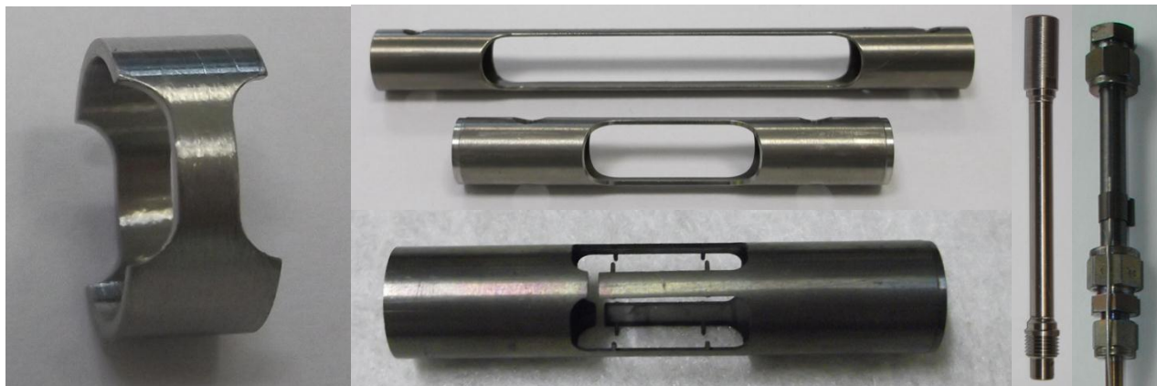
Exemples d'éprouvettes usinées dans des gaines de crayons combustibles
