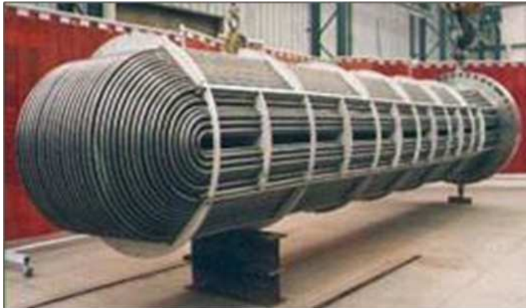
Tubes de Générateurs de Vapeur
